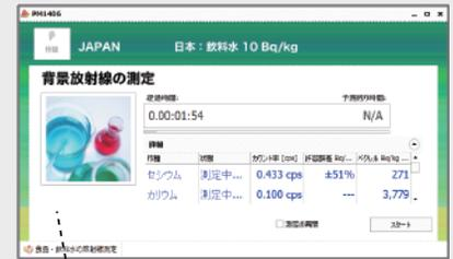
最初、測定器の周りの放射線量を測定します。
