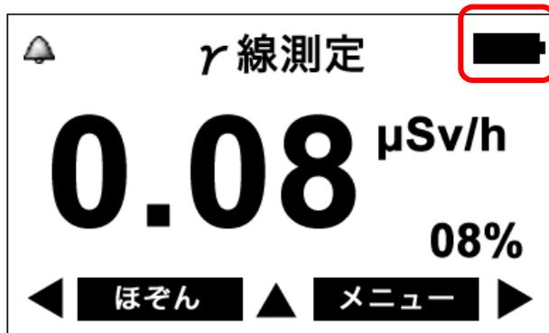
バッテリー残量が低下したら、以下の手順で、早めに電池を交換してください。
