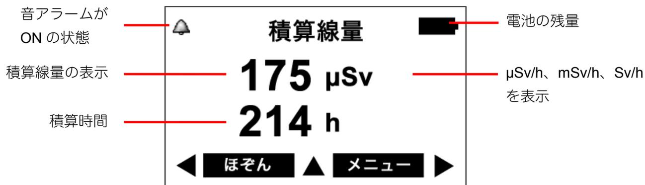
購入時には、0 より大きい数字になっていることがあります。理由は、測定器の校正を行った時の放射線の照射量や、測定器の動作テスト時に放射線を照射してテストするためです。
