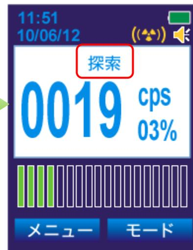
1秒あたりに捕捉された放射線の個数を cps で表示します。探索モードでは、放射線の強さに応じた音・振動アラームが発動し、放射線量の高い場所を探ることができます。
