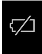
電池残量が低下している場合には、液晶に電池マークが5秒ほど表示され、電源が切れます。
