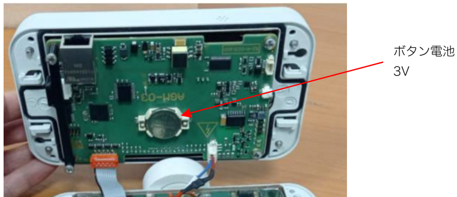
図 8-1 内蔵電池の交換
